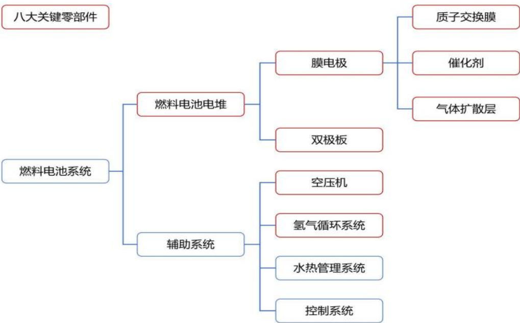
图 34：燃料电池系统主要构成
